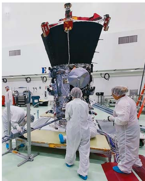
Установка магнитометров на “стрелу” космической солнечной обсерватории “Паркер” в Лаборатории прикладной физики университета им. Дж. Хопкинса (США). Фото NASA
