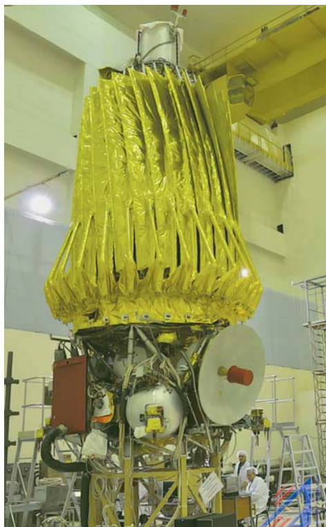
Космическая обсерватория “Спектр-Р” со сложенными “лепестками” антенны радиотелескопа в сборочном комплексе НПО им. С.А. Лавочкина, 2010 г. Фото НПО им. С.А. Лавочкина
